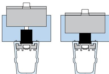
Válido para medidas de espesor de módulo de 28 mm a 40 mm. Para espesores diferentes solicitar bajo pedido.
