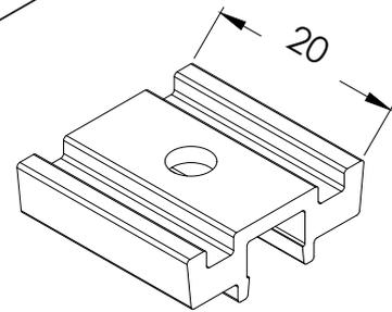
Introducir la parte inferior del presor en el perfil y alinear salientes del presor en la ranura del perfil.
