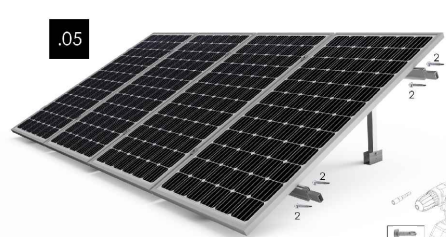
Kit 1 - Fixer les points du profilé de guidage inférieur à l'aide des vis de fixation (2 de chaque côté du joint). Répétez l'opération sur le profil de guidage supérieur.
