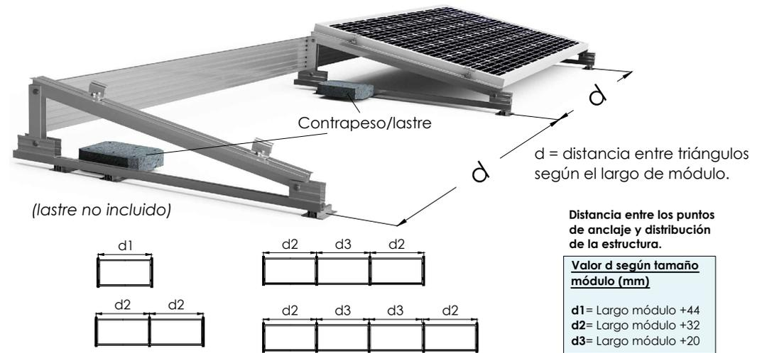
d = distancia entre triángulos según el largo de módulo.
