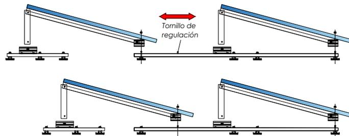
Soporte inclinado lastrado para cubierta plana. Horizontal.
