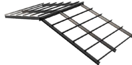
Vigas de acero (Anclaje solo a vigas de acero)
