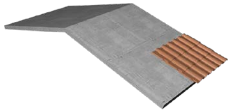
Losa de hormigón (espesor mínimo 15 cm)
