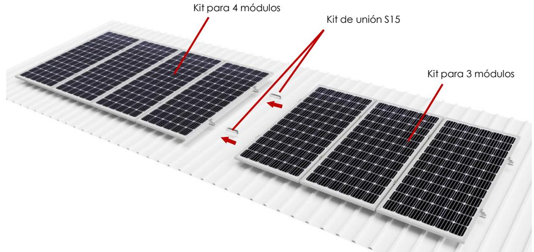
**Ejemplo fila para 7 módulos con soporte inclinado – Composición = 1 kit de 4 + 1 kit de 3**
